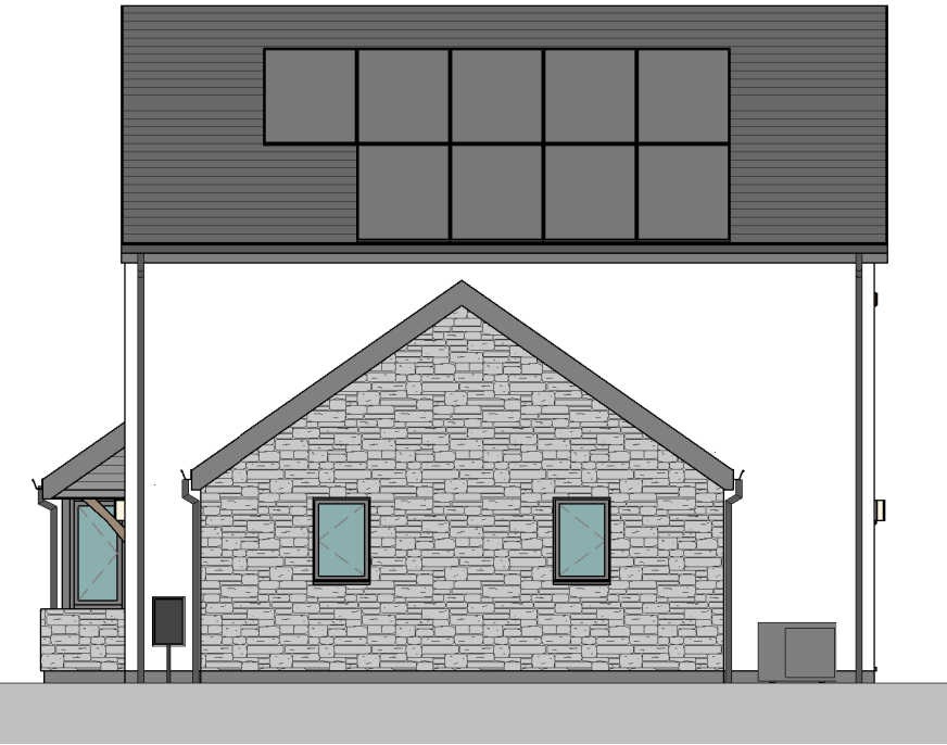
SIDE ELEVATION SCALE: 1 : 100
